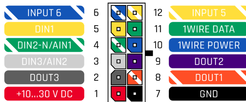
Рис.2 FMB130 распиновка разъема 2x6
